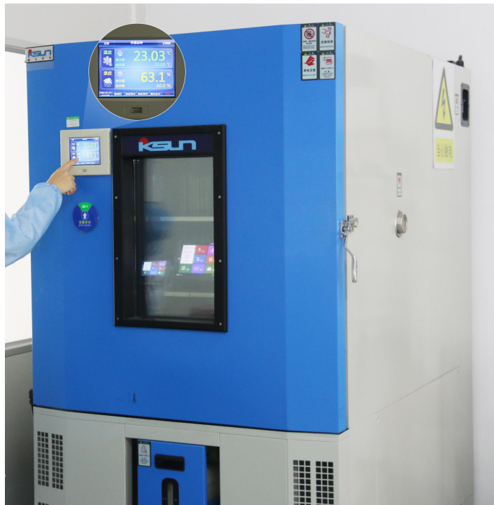
图 4-8 高低温老化测试图
